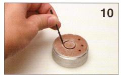
10. In der nähe des Modells ein Loch stechen damit ein Gießrohr entsteht. Gegenüber des Gießrohrs eine Entlüftungsröhre stechen.
