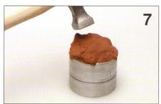
7. Den zweiten Ring mit Gießerde ausfüllen. Gießerde mit einem Hammer austampfen. Überflüssige Gießerde mit einem Lineal abstreichen.
