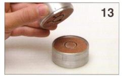
13. Die zwei Teile der Gießform wieder zusammen fügen. Die Einkerbungen genau einander gegenüber setzen. Die Gießform ist fertig zum Gießen.
