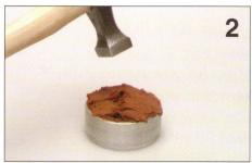
2. Den Ring mit der Gießerde ausfüllen und diese mit einem Hammer austampfen.
