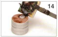
14. Wenn Sie das Metall geschmolzen haben, können Sie den Schmelztiegel während des Eingießens auf dem Rand liegen lassen. Dies erleichtert das Eingießen.
